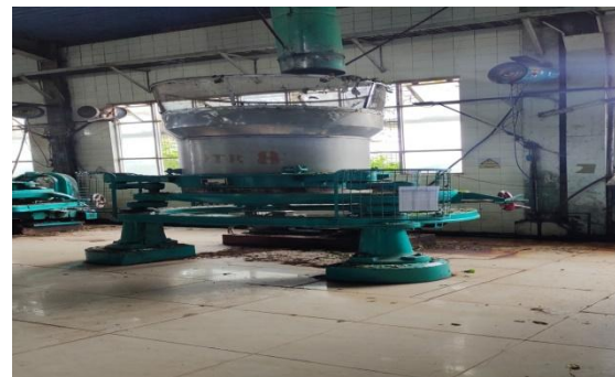
Gambar 1. Proses Penggulungan Daun Teh OTR
